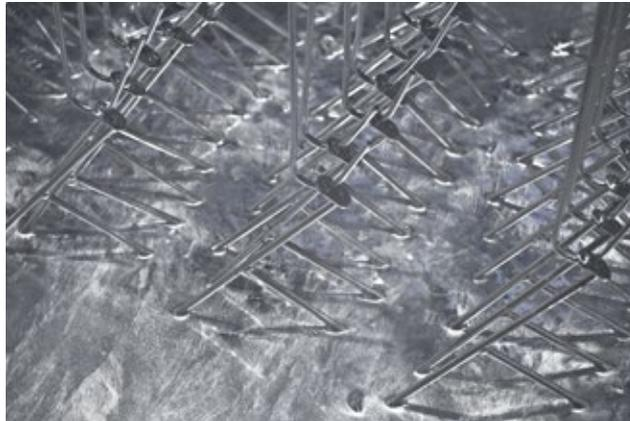
Tauchvorgang von traversierten Bauteilen im Hochtemperatur-Verzinkungskessel.
