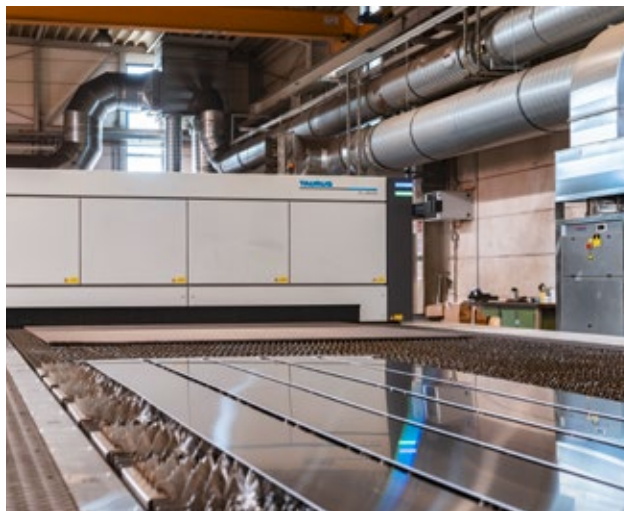
Einhausung der verfahrbaren Schneidkopfbrücke an einer 10-kW-Faserlaseranlage für Zuschnitte bis 3.000 x 25.000 mm.
