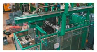
Das neue Herstellverfahren ermöglicht eine Beschleunigung des gesamten Schäumprozesses und in einer längeren Haltbarkeit der Werkzeuge. Im Bild der Formschaumautomat.
