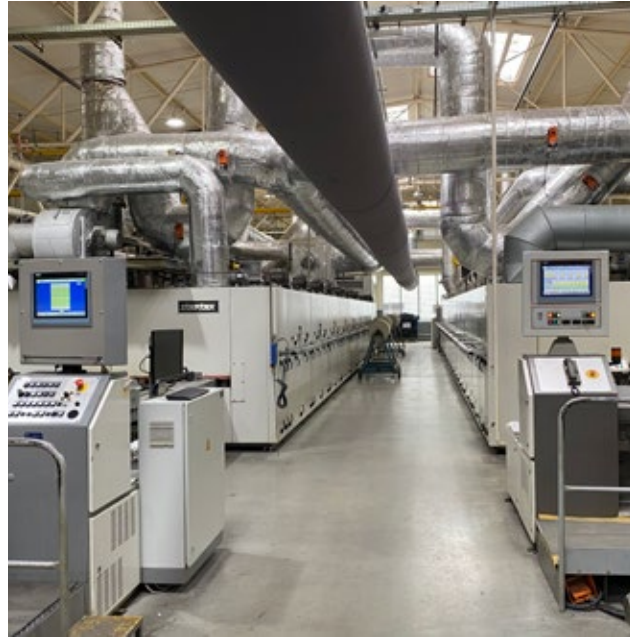
Der Spannrahmeneinlauf bei der AUNDE Achter & Ebels GmbH.
