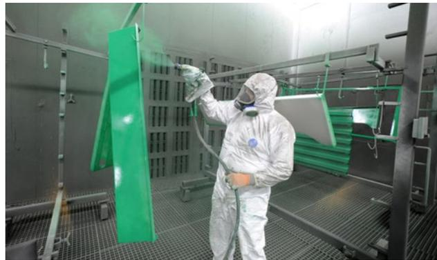
JENZ investierte in „Airless-Pistolen“, die nur wenig Druckluft für die Zerstäubung der Farbe benötigen.
