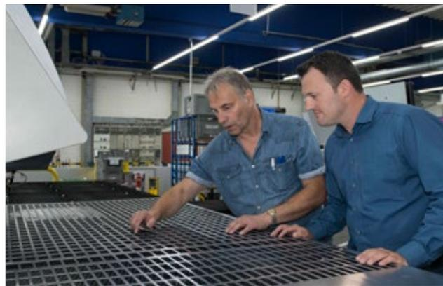
Die Firma Fischer Elektronik optimierte die Materialausbeute der Stanz- und Nibbelmaschine, an der Standard- und kundenspezifische Materialien aus Aluminium- und Stahlblechen hergestellt werden.
